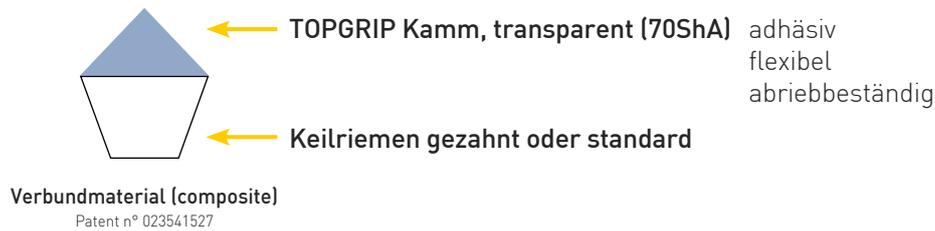
Der TOPGRIP Kamm kann auf alle Trapezprofile – Keilriemen aufgeschweißt werden (außer auf die DEL/ROC Profile). Das ermöglicht eine große Auswahl an Kamm-Profilen für verschiedene Anwendungen, Fördergüter und Scheibendurchmesser.
