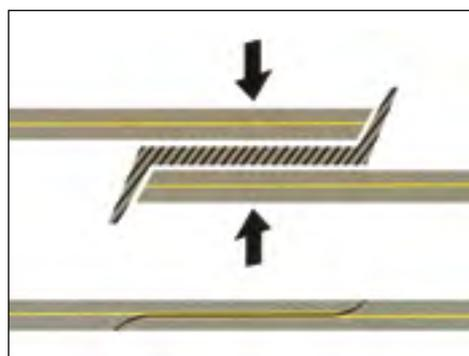
Schweißverfahren bei dem die Band-/Riemenenden einander überlappen. Anwendbar bei allen Profilen in unserem Sortiment:
