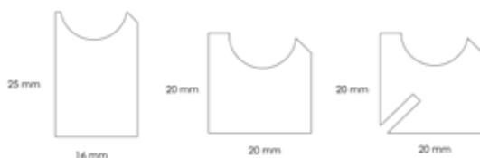
La flexibilidad de esta corredera permite su colocación por combadura en un transportador curvo.
