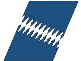
Die DEL/DRIVE® 50, POSITIVEBELT® and S/DRIVE® Transportbänder können mit mechanischer Endverbindung geliefert werden, um das Demontieren und Montieren zu erleichtern. Dabei muss lediglich der Verbindungsstab entfernt und beim Einbau wieder eingeführt werden.
