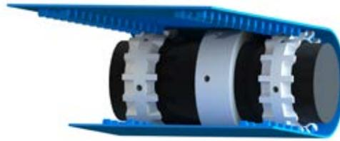
Pignons PEHD à monter sur bague inox, bloqués avec vis de pression.
