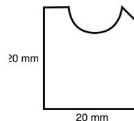
Die Biegsamkeit dieser Gleitschienen ermöglicht die Installation in Kurven-Förderern. Es sind zwei Standard Varianten für Rundriemen bis 12 mm Durchmesser erhältlich: 25 x 16 mm and 20 x 20 mm.
