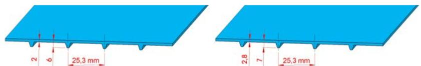
Das DEL/DRIVE® 25 Band ist ein biegsames und leichtes Band mit geringerer Stärke und kürzerem Zahnabstand. Es findet bei den kleinsten Rollendurchmessern Anwendung. Es reduziert den Platzbedarf der Förderanlagen und erleichtert eine Übergabe der beförderten Produkte.
