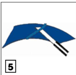
Die Schweißnaht entgraten.
